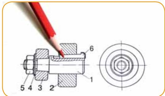
خارها و گوه ها برای اتصال و انتقال حرکت اجزای گردان مثل چرخ دنده ها ، چرخ تسمه ها و ... بر روی محور - جهت اتصال موقت - مورد استفاده قرار می گیرند. متداول ترین خارها عبارت اند از: خارهای منشوری و خارهای هلالی (ناخنی). متداول ترین گوه ها نیز به صورت شیب دار، ساده یا دماغه دار مورد استفاده قرار می گیرند .
