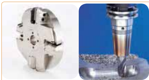
فرم های مختلف هندسی روی قطعات متناسب با شکل هندسی و جهت حرکت ابزارها پدید می آیند.
