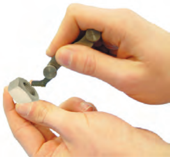
شکل ۱۳-۸- تعیین تعداد دندانه در یک اینچ مهره
