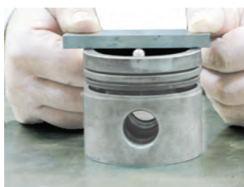
شکل ۶-۸- اندازه‌گیری پیستون با گلوله‌ی اندازه‌گیری
