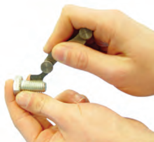
شکل ۱۱-۸- تعیین تعداد دندانه در یک اینچ پیچ اینچی
