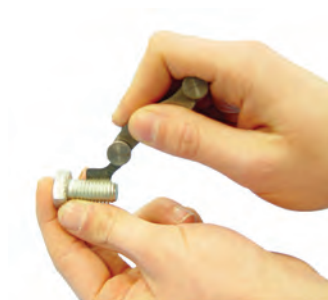
شکل ۱۰-۸- تعیین گام پیچ
