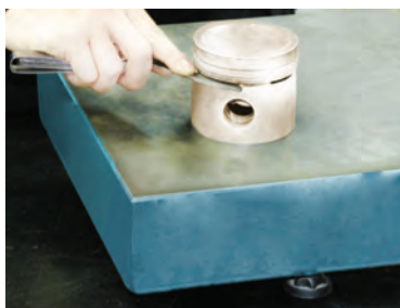
شکل ۵-۸- اندازه‌گیری پیستون توسط فیلر
