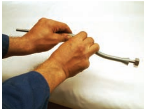
۱- خم زدن لوله‌ی پیسوار به وسیله‌ی فنر
