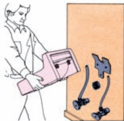
شکل ۲۴-۱۰ مراحل نصب دست‌شویی بدون پایه
