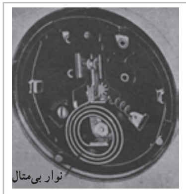
شکل ۹-۱۴- نمای داخلی یک ترموستات، با نوار دو فلزی حلقه شده
