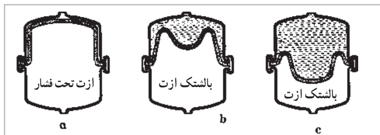
شکل ۸-۱۲- مخزن انبساط بسته دیافراگمی
