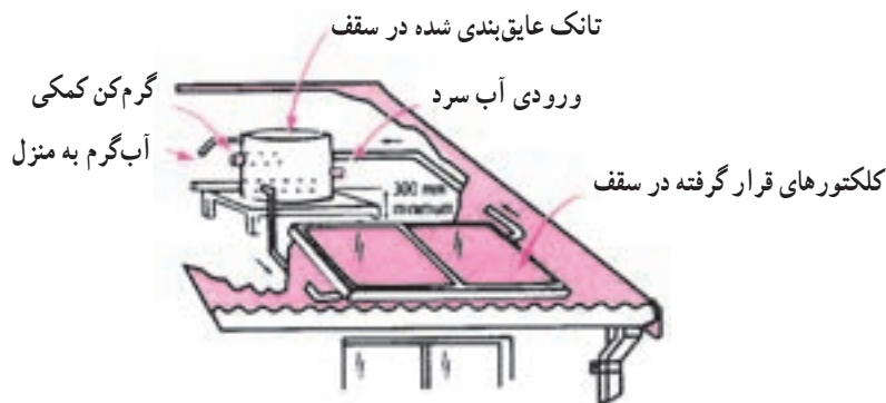
شکل ۹-۱۳- سیستم ترموسیفونی با مخزن مجزا (فشار ثابت)
