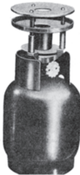
شکل ۴-۵- انواع کوره‌ی ذوب سرب
