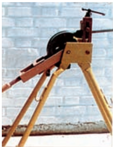
شکل ۱۲-۶ - مراحل مختلف خم کردن لوله فولادی
