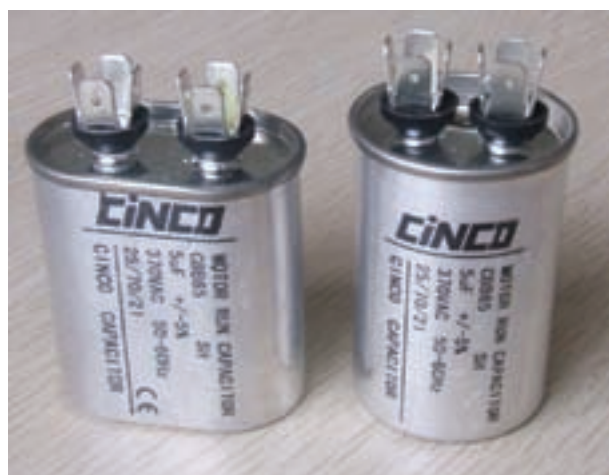
شکل ۲-۳۸- خازن کار و خازن استارت
