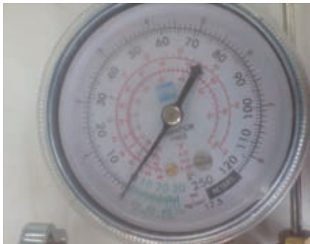
شکل ۲-۵۴- فشار سنج مرکب مانیفولد
