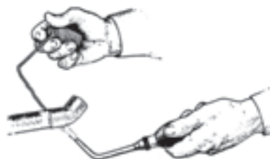
شکل ۲-۱۹- زدن لحیم برای درز گرم شده. لحیم را با شعله ذوب نکنید. پس از رسیدن اتصال به دمای معین لحیم ذوب شده و درز را پر می کند.
