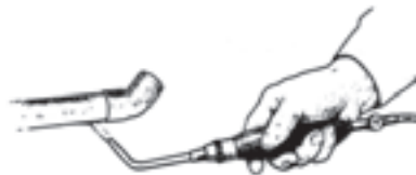
شکل ۲-۱۷- گرم کردن لوله ی مسی آب. لوله در ابتدا لحظه ای گرم می شود. به طوری که گرما به سر لوله برسد. شعله را به آرامی از فیتینگ دور کنید.
