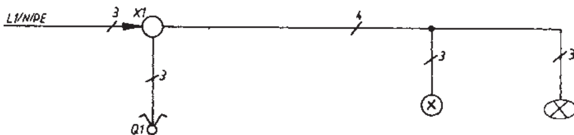
ب - شمای فنی یک کلید دو پل همراه با یک لامپ معمولی و لامپ فلورسنت
