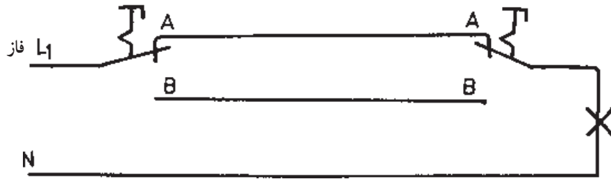
شکل ۲۳-۵- چگونه ارتباط دو کلید با یکدیگر
