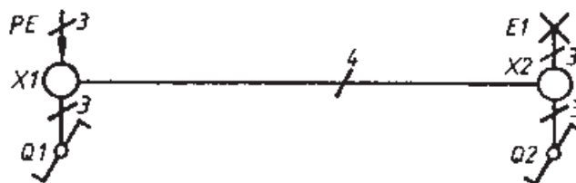
شکل ۳۶-۵- (الف) شمای عملی دو کلید تبدیل همراه با یک لامپ روشنایی (ب) شمای فنی دو کلید تبدیل همراه با یک لامپ روشنایی
