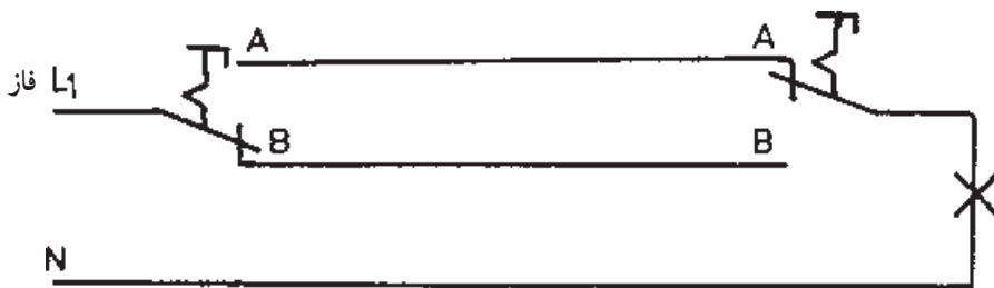
شکل ۲۴-۵- ارتباط الکتریکی لامپ قطع شده است.
