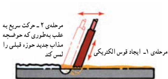
شکل ۳-۴- تشکیل مهره جوش
