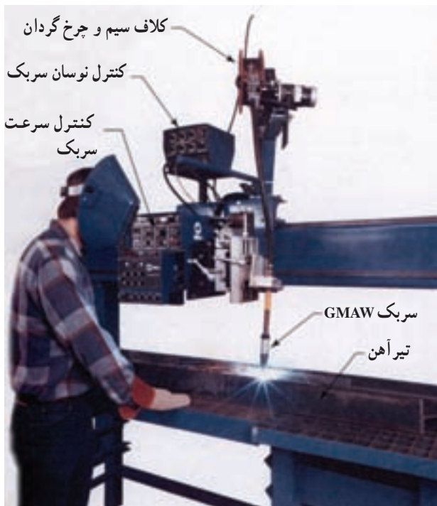
شکل ۳-۵- دستگاه جوش GMAW
