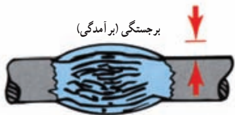
شکل ۱۳-۶ - جوش واژگونه سر به سر
