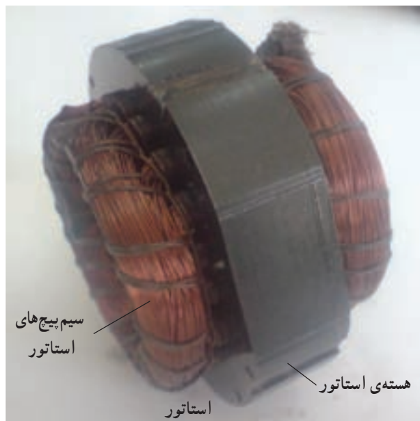
شکل ۱-۲ استاتور و روتور یک کمپرسور بسته‌ی تناوبی
