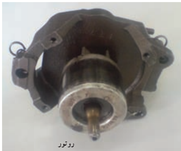
شکل ۱-۲ استاتور و روتور یک کمپرسور بسته‌ی تناوبی
