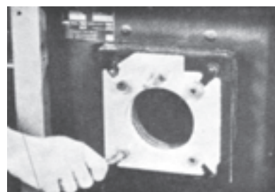
شکل ۲۸-۲- نصب پیچ دو سر دنده و فلنج
