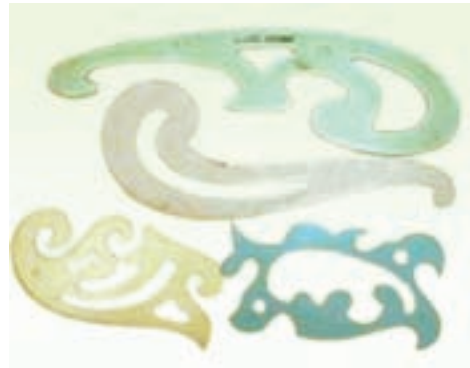
شکل ۱-۱۹- نمونه‌هایی از منحنی‌کش یا پیستوله
