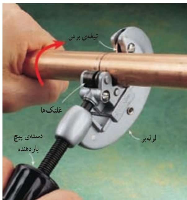
شکل ۱-۱۱- طریقه‌ی بریدن لوله‌ی مسی با لوله‌بر
