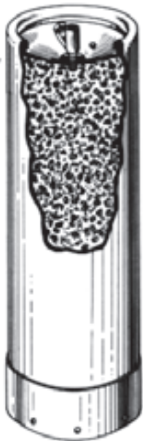
شکل ۵-۲- نمای داخل کپسول استیلن
