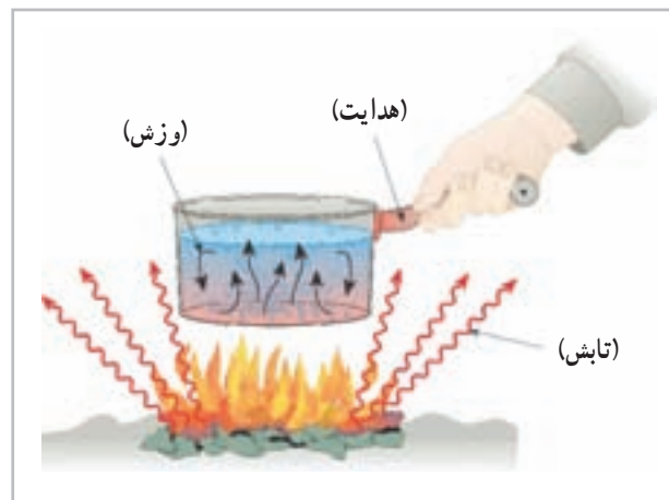
شکل ۱-۶- روش‌های انتقال گرما
