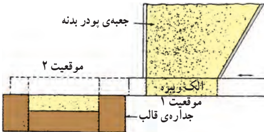
شکل ۸-۴- سیستم اتوماتیک پرکننده‌ی قالب کاشی
