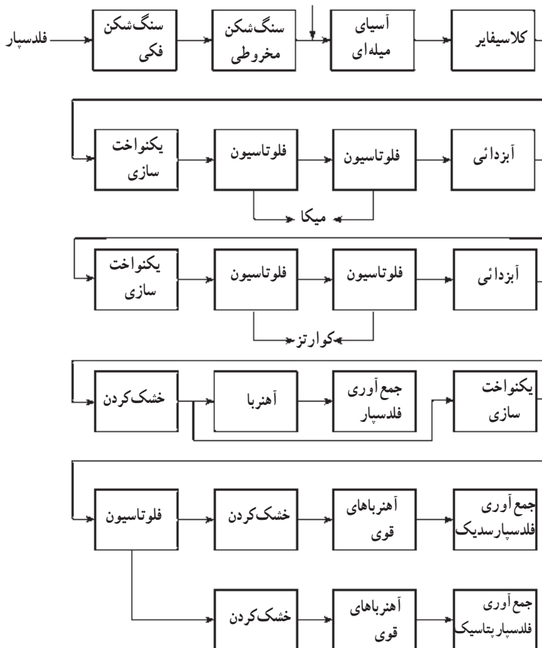
شکل ۶-۳- کانه آرای و نستشوی فلدسپارها از طریق فلوتاسیون
