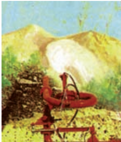
شکل ۱-۳- یک جت آب برای استخراج کائولین
