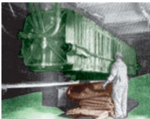
شکل ۱-۲۴- فیلتر پرس در حال تخلیه (به کیک‌های خارج شده از دستگاه دقت کنید)
