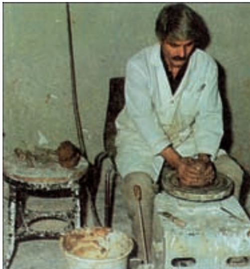
شکل ۴-۱- گل در مرکز چرخ قرار داده می‌شود.
