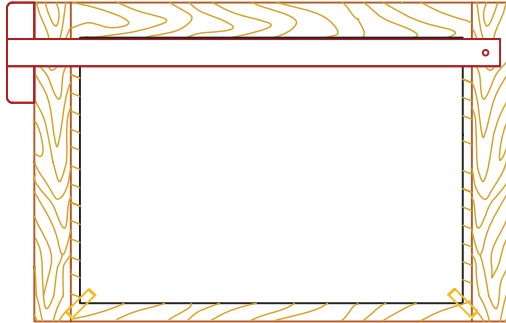
ج) تنظیم لبه‌ی بالایی کاغذ با لبه‌ی خط‌کش تی و چسب زدن
