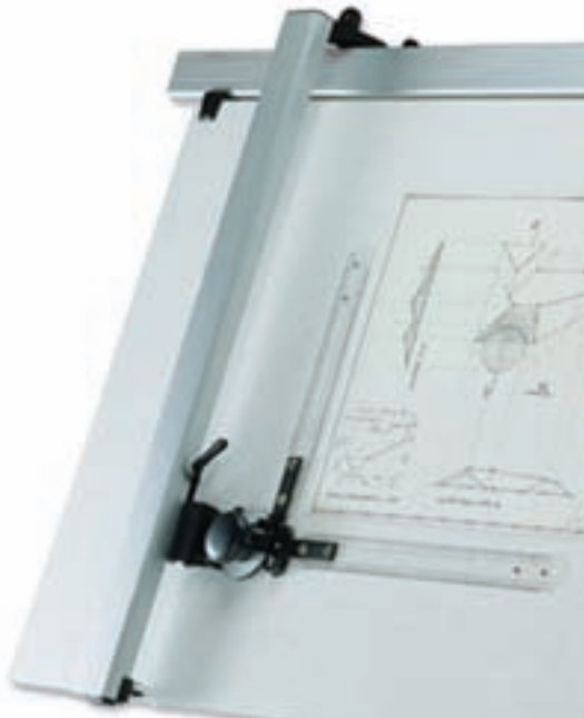
شکل ۳-۱- میز نقشه‌کشی با خط‌کش ریلی متحرک
