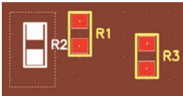
شکل ۳-۱۹ انتقال مقاومت روی فیبر مدار چاپی
