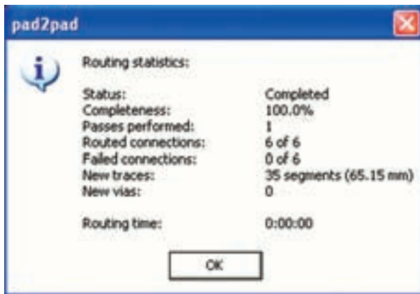
شکل ۳-۳۴ مشخصات فیبر مدار چاپی پس از مسیر یابی خودکار
