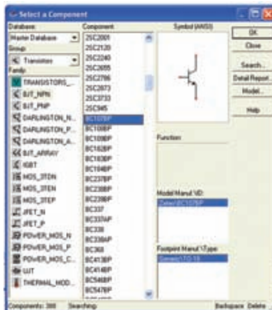
شکل ۴-۵ انتخاب ترانزیستور با شماره‌ی خاص
