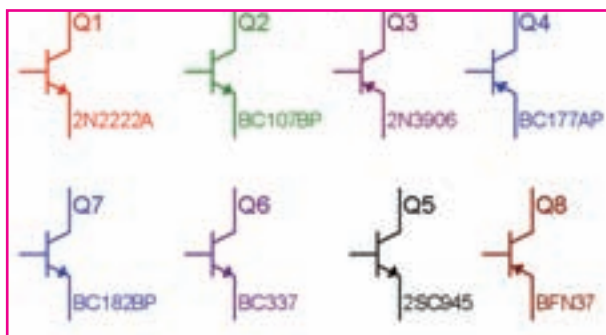
شکل ۴-۶ انواع ترانزیستور با شماره‌ی فنی
