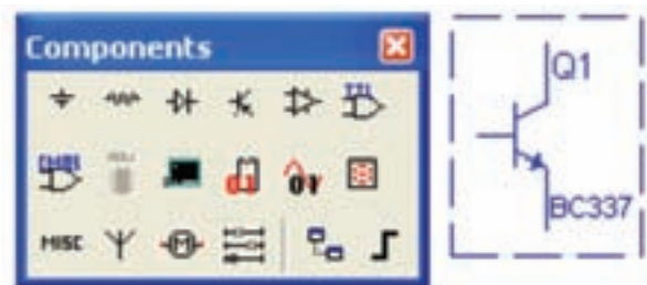
شکل ۲-۴ نحوه‌ی قراردادن ترانزیستور از طریق نوار ترانزیستور
