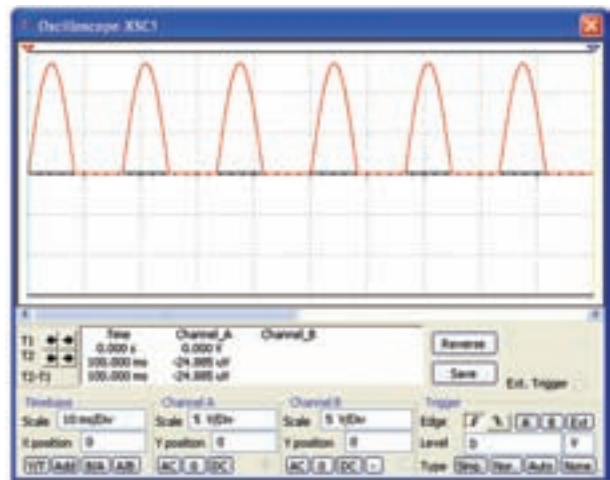
شکل ۳-۴ مدار و شکل موج یکسوساز نیم‌موج
