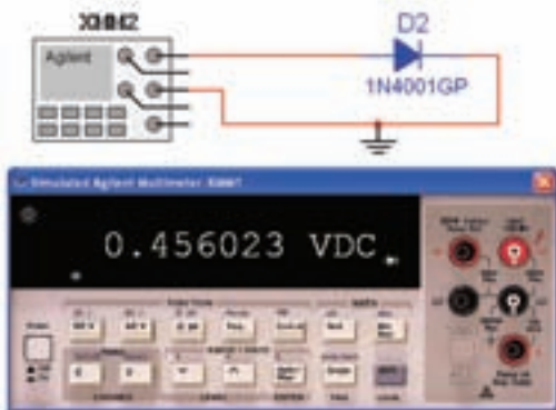
شکل ۲۱-۲ آزمایش دیدود در بایاس موافق
