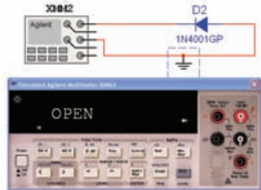
شکل ۲۲-۲ آزمایش دیود در بایاس مخالف
