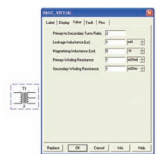
شکل ۱-۴۳ تنظیم نسبت ترانسفورماتور
