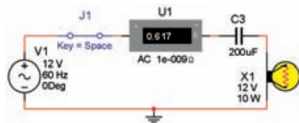
شکل ۷-۹ ظرفیت خازن 200\mu F و لامپ با نور بسیار زیاد روشن است
