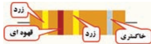
شکل ۲-۷- دیود با نوارهای رنگی
