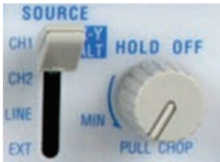
شکل ۵-۶- ولوم های Alt، Chop و Hold off
