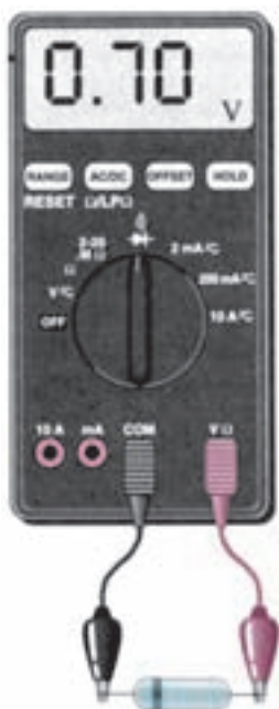
شکل ۹-۷ تعیین پایه ها و جنس دیود با استفاده از مولتی متر دیجیتالی
