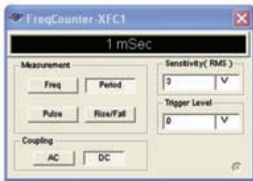
شکل ۶-۷ استفاده از فرکانس متر در اندازه‌گیری زمان تناوب
