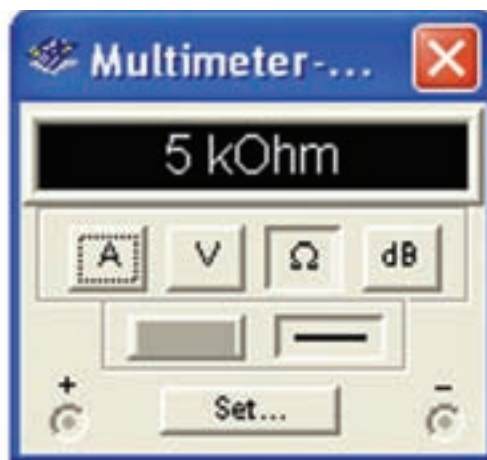
شکل ۳-۲ اندازه‌گیری مقاومت کل در مدار سری
