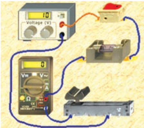
شکل ۱-۱۳ در مدار پتانسیومتر فیوز سوخته است
