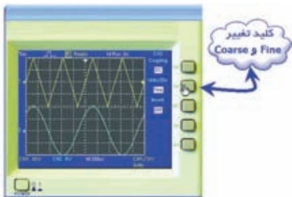
شکل ۲-۱۰۸ انتخاب کلید FINE برای تنظیم دقیق تر دامنه
