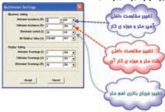
شکل ۲-۷۷ تنظیم دقت مولتی‌متر
