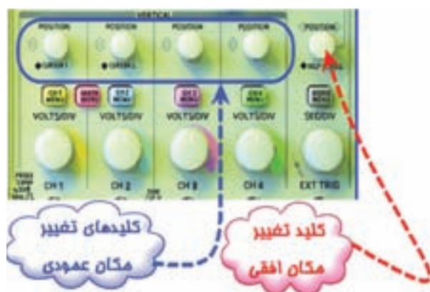
شکل ۲-۹۶ کلیدهای تغییر موقعیت عمودی و افقی
