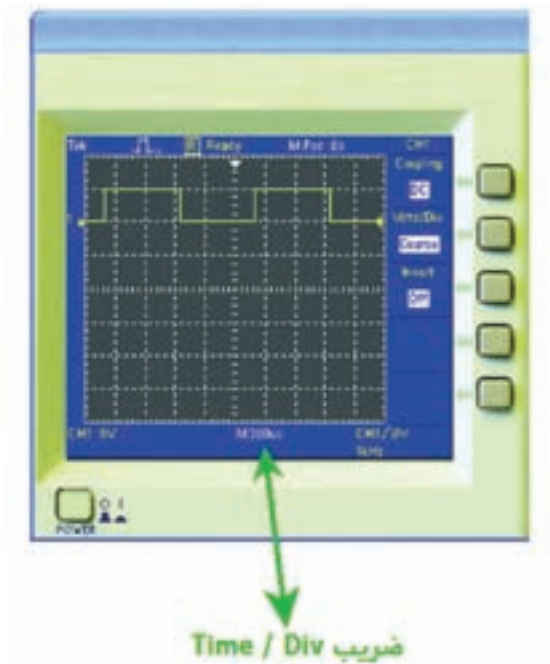
شکل ۲-۱۰۴ اندازه‌گیری زمان تناوب
