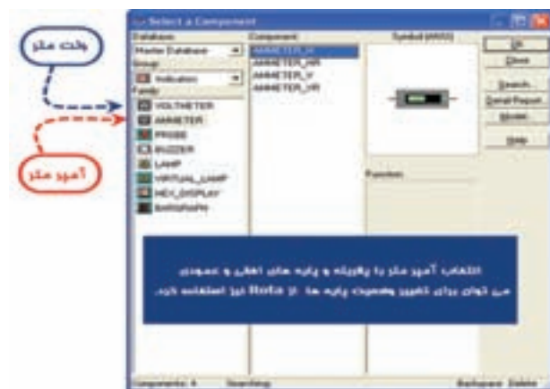
شکل ۲-۷۳ انتخاب آمپرتر و ولت‌متر از منوی نشان‌دهنده
