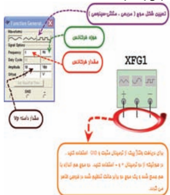
شکل ۸۰-۲ فانکشن‌ژنراتور و صفحه‌ی تنظیم آن
