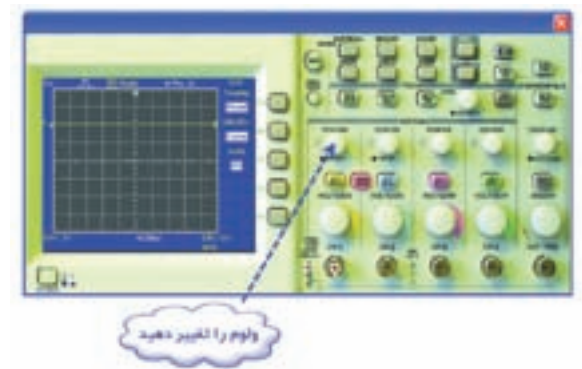
شکل ۲-۱۰۲ تغییر مکان عمودی خط GND
