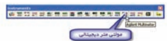
شکل ۱۳۴-۲ موقعیت مولتی‌متر دیجیتالی در نوار ابزار
