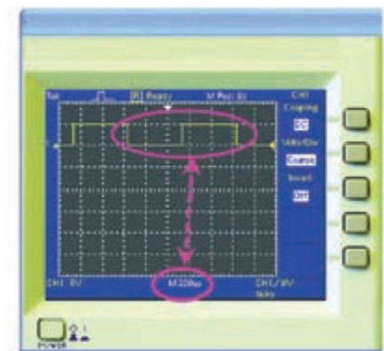
شکل ۲-۱۰۵ اندازه‌گیری زمان تناوب موج مربعی
