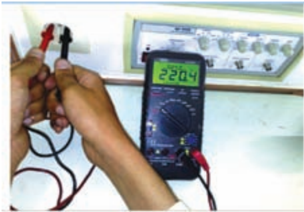
شکل ۲-۷۹ اندازه‌گیری ولتاژ برق شهر
