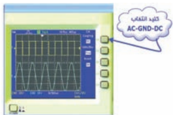
شکل ۲-۹۴ کلید انتخاب ورودی AC-GND-DC
