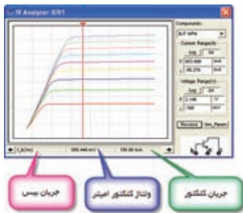
شکل ۱۳۳-۲-ب- مشخص شدن نقطه‌ی کار
