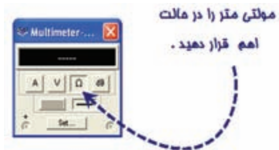
شکل ۲-۶۳ مولتی متر در حالت اهم متر
