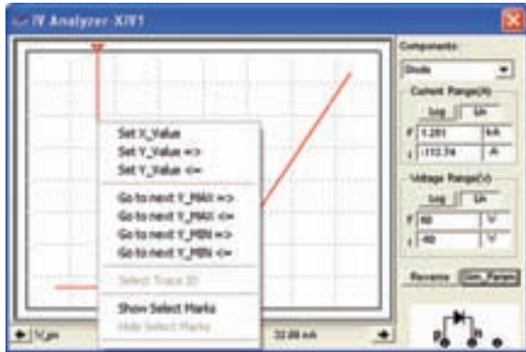
شکل ۲-۱۲۹-ب- صفحه‌ی تنظیمات دستگاه کروتریسر
