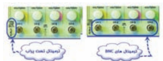
شکل ۲-۹۲ ترمینال تست پراب و کانال‌های ورودی دستگاه
