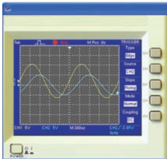
شکل ۲-۱۱۷ اندازه‌گیری اختلاف فاز
