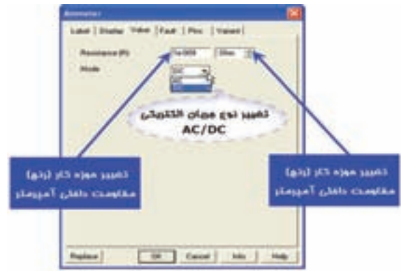
شکل ۲-۷۴ صفحه‌ی تنظیمات تعیین رنج آمپرتر
