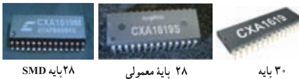
شکل ۸-۶- تصویر ظاهری دو نمونه IC گیرنده رادیویی AM/FM
