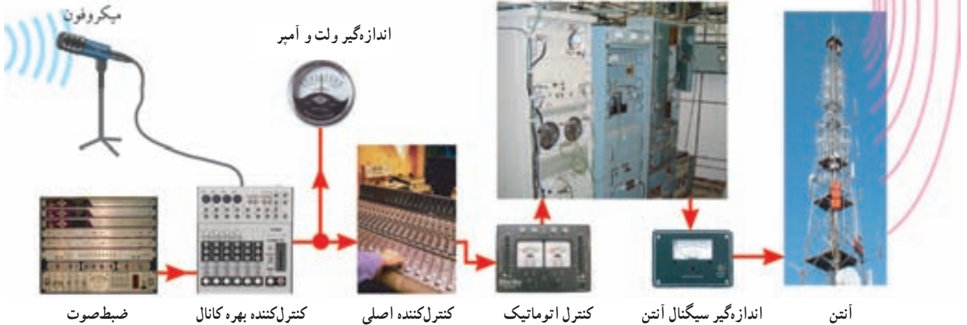
شکل ۱۹-۶- بلوک دیاگرام کلی فرستنده
