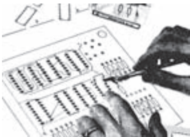
شکل ۲۹-۴- نحوه چسباندن لتراست مربوط به پایه قطعات
