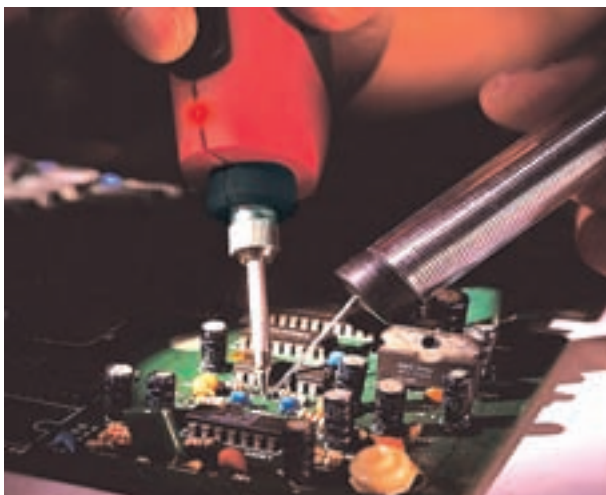
شکل ۸۷-۱- لحیم کاری روی یک بُرد شلوغ
