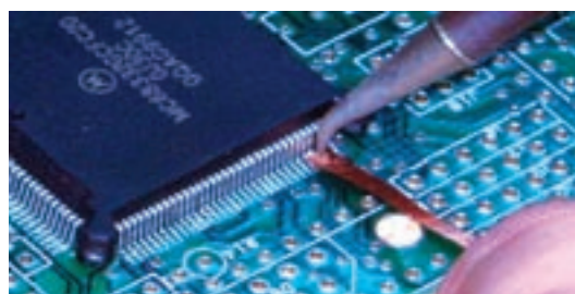
شکل ۱-۷۵- جدا کردن آی سی با فتیله لحیم
