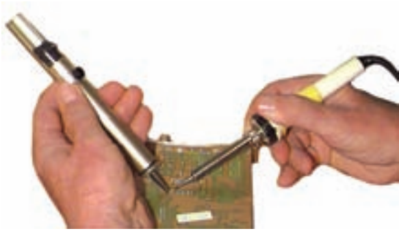
شکل ۱-۷۳- نمونه دیگری از کار قلع کش پیستونی
