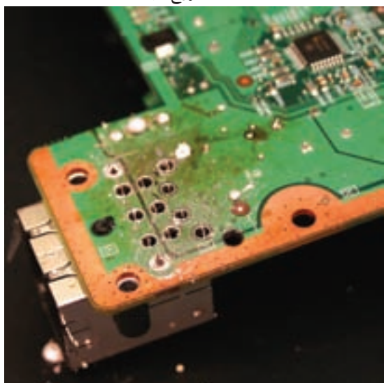
ب) برداشتن لحیم ها و آزاد کردن پایه ها
