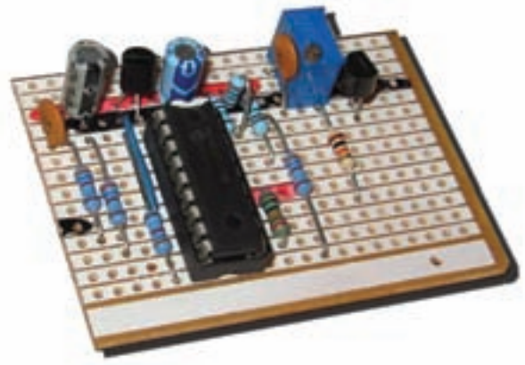
شکل ۱-۱۰۴- یک نمونه مدار کامل روی فیبر سوراخ‌دار
