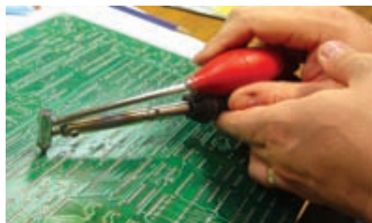
شکل ۱-۷۶- دمونتاز قطعات با استفاده از قلع کش حرارتی
