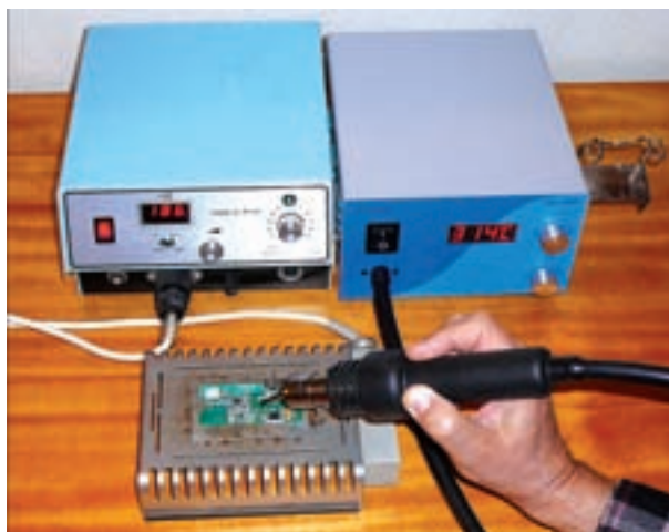
شکل ۸۶-۱- هویه با تنظیم دمای الکترونیکی
