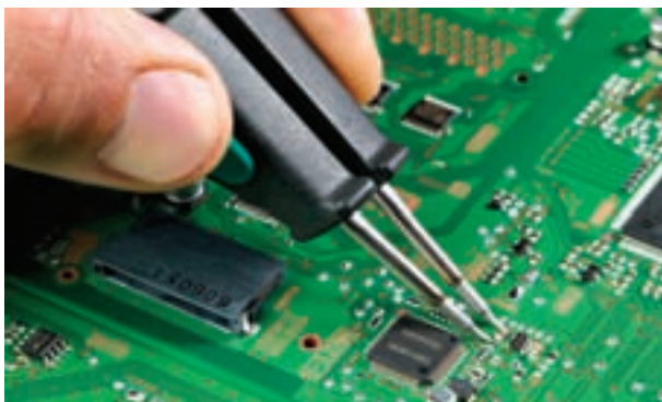
شکل ۸۸-۱- استفاده از هویه پرسی شکل
