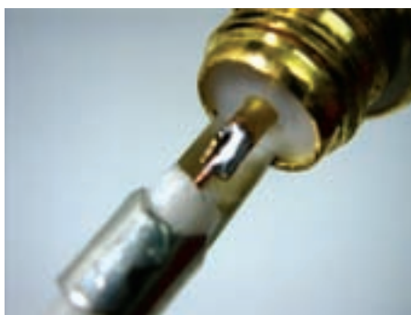
شکل ۱-۹۷- اتصال کابل کوآکسیال به BNC
