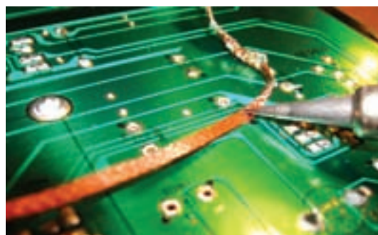
شکل ۱-۷۴- چگونگی استفاده از فتیله لحیم
