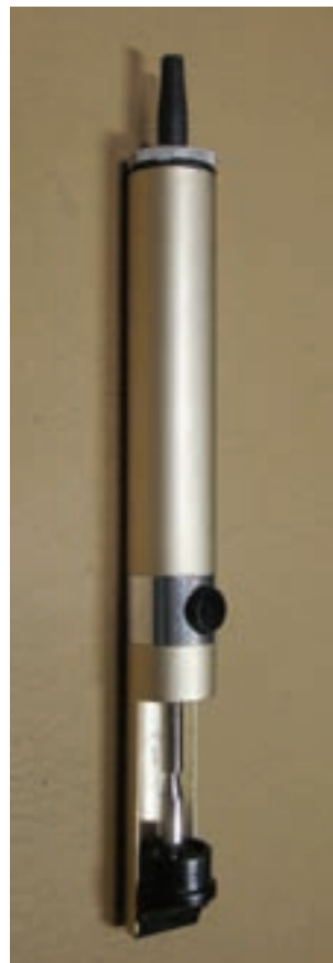
شکل ۱-۶۵- دو نوع قلع‌کش پیستونی
