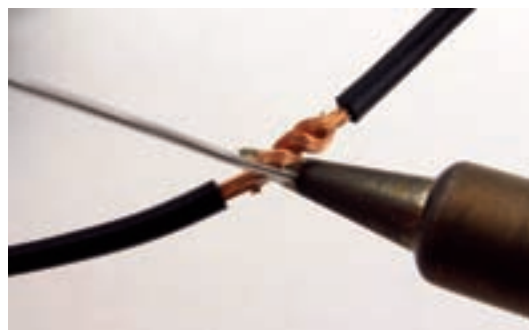
شکل ۱-۵۳- چگونگی اجرای لحیم کاری برای اتصال دو سیم افشان
