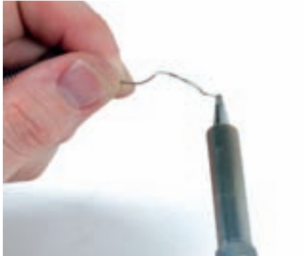
شکل ۴۰-۱- اضافه کردن لحیم به نوک هویه
