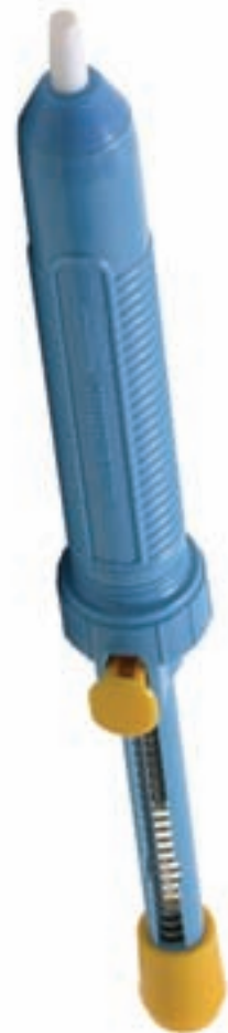
شکل ۱-۶۵- دو نوع قلع‌کش پیستونی
