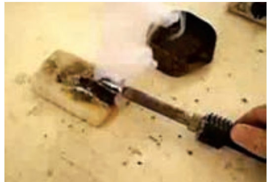
شکل ۳۸-۱- ساده ترین راه تمیز کردن نوک هویه
