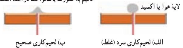
شکل ۱-۴۵- لحیم کاری صحیح و غلط
