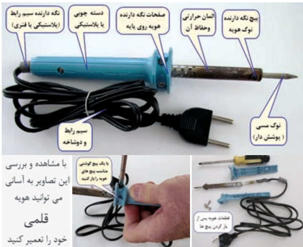
شکل ۲۷-۱- قسمت‌های مختلف یک هویه قلمی
