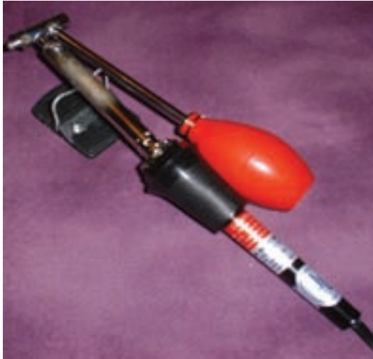
شکل ۱-۶۶- نمونه‌ای از قلع‌کش حرارتی با پمپ دستی
