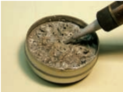
شکل ۳۹-۱- فرو کردن نوک هویه در روغن لحیم
