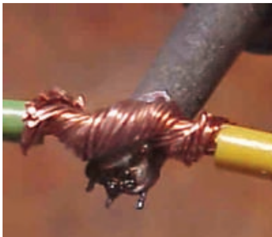
شکل ۴۴-۱- گرم کردن محل لحیم کاری قبل از اضافه کردن لحیم
