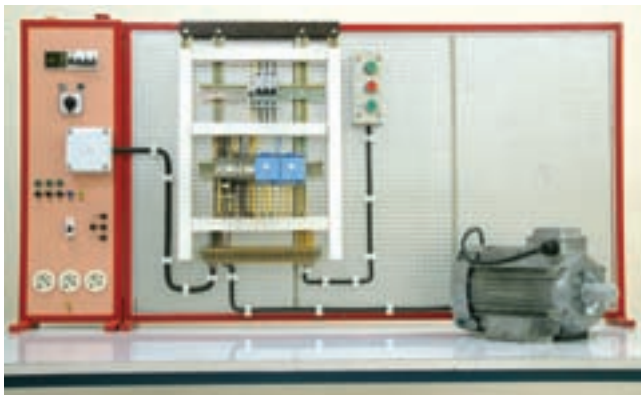
شکل ۳-۴- راه اندازی موتور سه فاز آسنکرون به صورت چپ گرد، راست گرد بدون توقف (سریع) با تایمر
