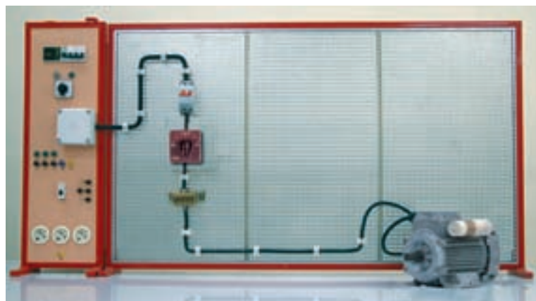
شکل ۱-۳- راه‌اندازی موتور تک‌فاز با کلید چپ‌گرد، راست‌گرد زبانه‌ای
