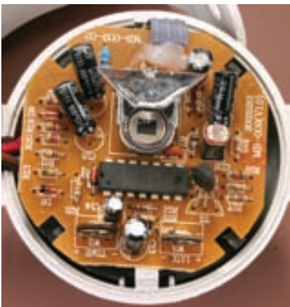
شکل ۵-۴۲ اجزای داخلی (PIR)
