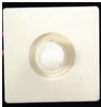
شکل ۳۹-۵ رله نوری الکترونیکی
