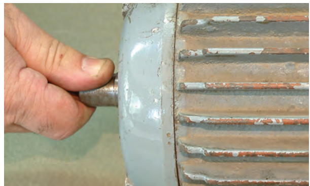
شکل ۳۰-۶ - آزمایش لنگی (لقی) بوش‌ها یا بلبرینگ‌ها
