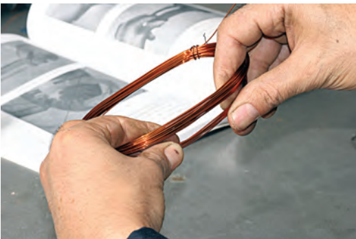
شکل ۱۶-۶- مرتب کردن سیم‌ها جهت کلاف گذاری
