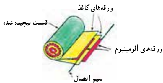
شکل ۱-۲۹- طرز قرار گرفتن ورقه‌های آلومینیوم
