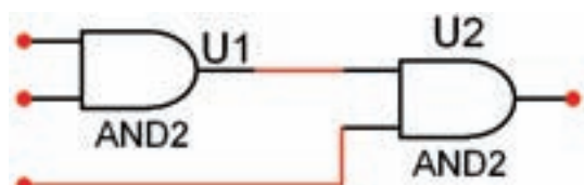
شکل ۲-۳۵ افزایش ورودی‌ها در گیت منطقی AND
