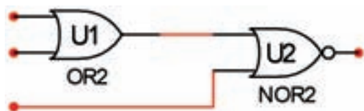
شکل ۲-۴۷ گیت NOR با سه ورودی
