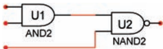
شکل ۲-۴۳ گیت NAND با سه ورودی
