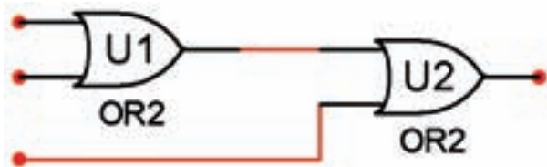
شکل ۲-۳۹ گیت OR با سه ورودی
