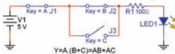
شکل ۲-۱۱ مدار ترکیبی AND در OR
