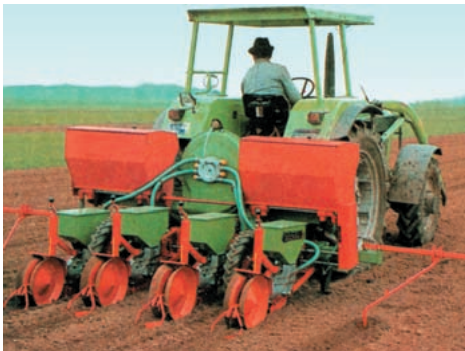
شکل ۲-۴- یک ردیفکار پنوماتیکی حین انجام کار
