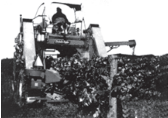
شکل ۹-۴- برداشت میوه انگور به وسیله ماشین برداشت
