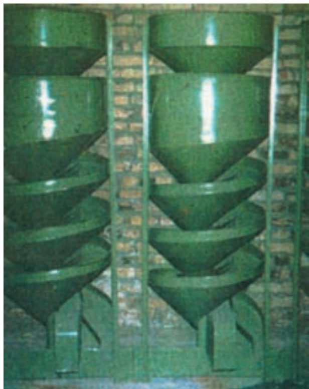
شکل ۱-۳- یک نوع دستگاه بوجاری
