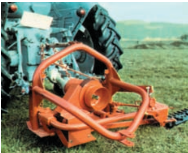
شکل ۹-۱- طرز کار دروگر شانهای
