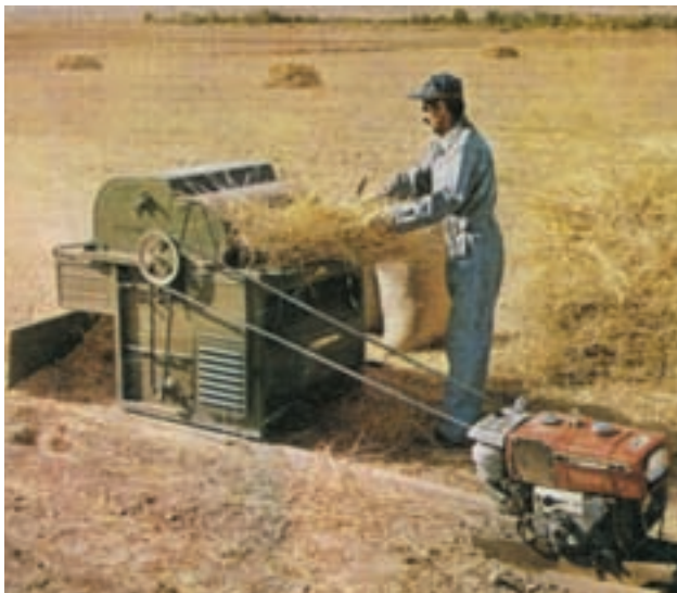
شکل ۲۳-۱- خرمنکوب با موتور تیلر در حال کار
