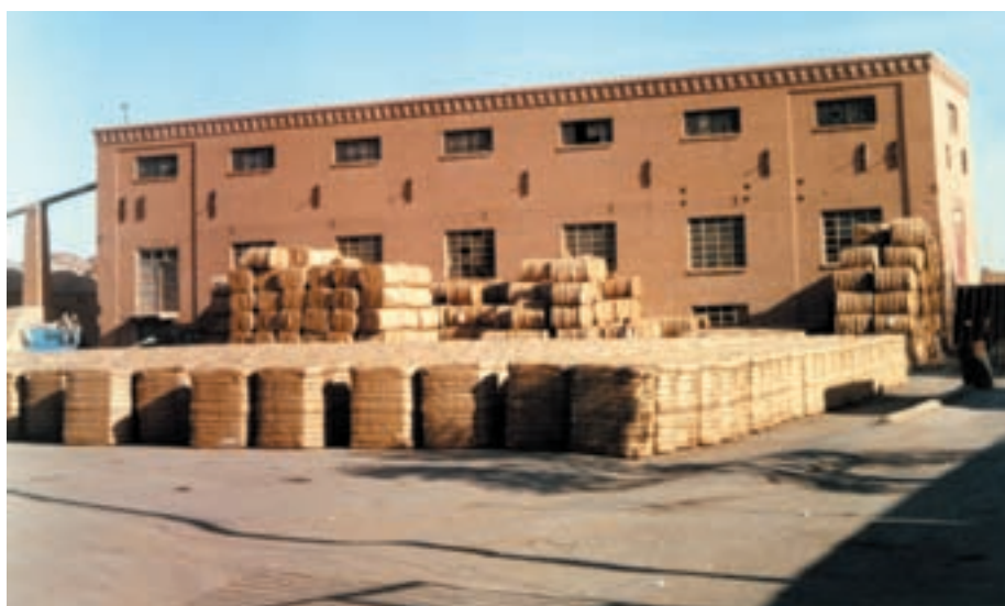
شکل ۱۱-۶- پنبه پس از جدا کردن دانه، تبدیل به پنبه محلولج و عدل بندی می شود و آماده انتقال به کارخانجات نساجی می گردد (هر عدل در کشور ما، ۱۷۴ کیلوگرم است.)
